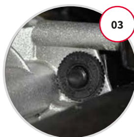
Breaker de seguridad
